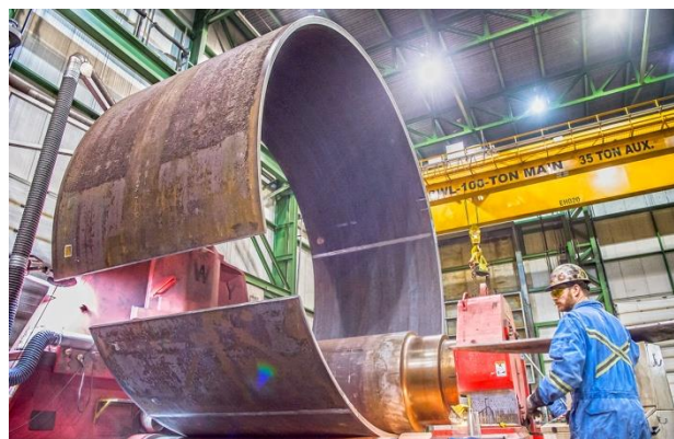
Slika 2. Kružno savijanje lima pomoću valjaka
