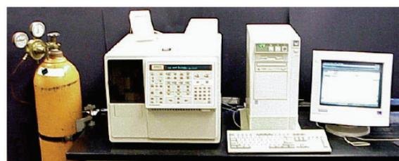
Slika 5. Noseći gas sa regulatorima, gasni hromatograf i računar za obradu podataka
