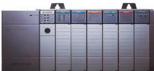
Slika 2. Izgled PLC-a proizvođača Allen Bradley SLC 500.
