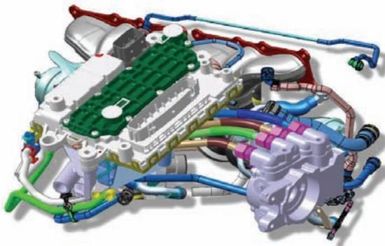
Slika 3. Sklop motora sa priključnim cevima za protok fluida
