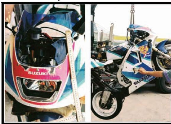
Slika 3. Izgled oštećenja motocikla Suzuki RGV 250
