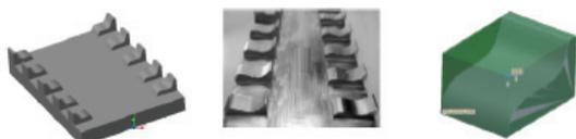
Slika 11. CAM modeli obrade i obrađeni delovi
