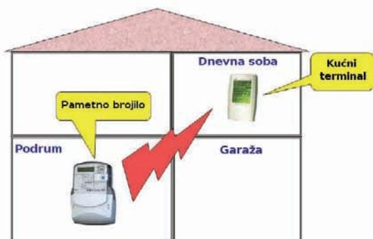
Slika 2: Princip rada kućnog terminala
