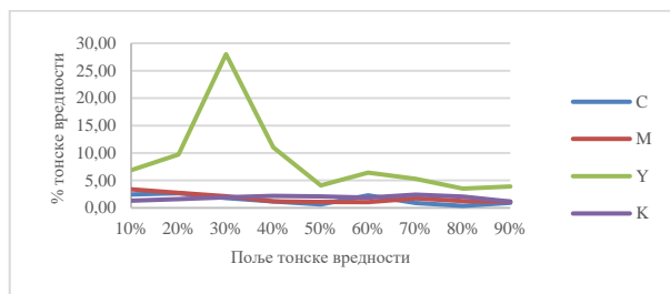
График 7. Разлика максималне и минималне средње вредности мерења пораста тонске вредности на папиру Новел 80 g/m 2 и машини Ricoh Pro 8100se
