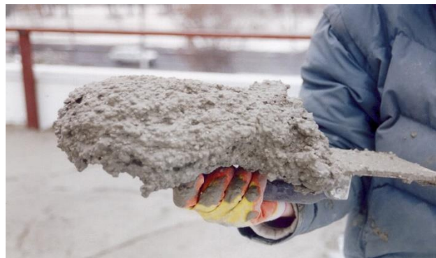
Slika 5. Simprolit monolit – superlaki beton
