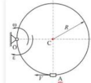
3. Obuci poluprečnika  $R=1$  m zglobno je vezan u tački O za podlogu i obrće se u ravni crteža. Po obuci se relativnom brzinom konstantnog intenziteta  $\ell$  kreće klizač A. U prikazanom položaju obuci ma ugaonu brzinu  $\omega=1 \text{ s}^{-1}$  i ugaono ubrzanje  $\varepsilon=1 \text{ s}^2$ , dati smerova. Odrediti apsolutnu brzinu i apsolutno ubrzanje klizača u zadatom položaju.
