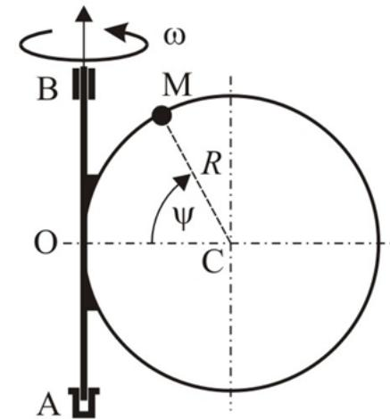
3. Obruč, radijusa  $R=1$  m, obrće se oko vertikalne ose AB konstantnom ugaonom brzinom  $\omega=1 \text{ s}^{-1}=const$ . Po obruču se kreće prsten M po zakonu  $\psi(t) = \frac{\pi}{2} + t^2 - 1$  [rad]. Odrediti apsolutnu brzinu i apsolutno ubrzanje prstena u trenutku  $t_1=1$  s.
