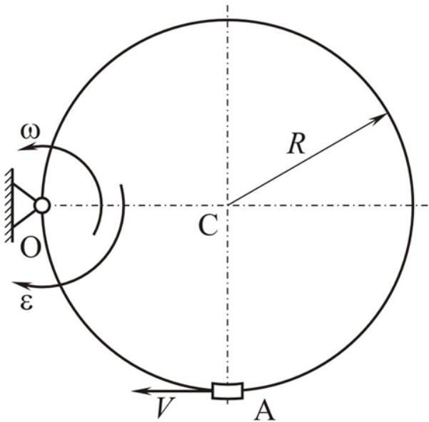
3. Obruč poluprečnika  $R=1$  m zglobno je vezan u tački O za podlogu i obrće se u ravni crteža. Po oboruču se relativnom brzinom konstantnog intenziteta  $V$  kreće klizač A. U prikazanom položaju oboruč ima ugaonu brzinu  $\omega=1 \text{ s}^{-1}$  i ugaono ubrzanje  $\epsilon=1 \text{ s}^{-2}$ , datih smerova. Odrediti apsolutnu brzinu i apsolutno ubrzanje klizača u zadatom položaju.
