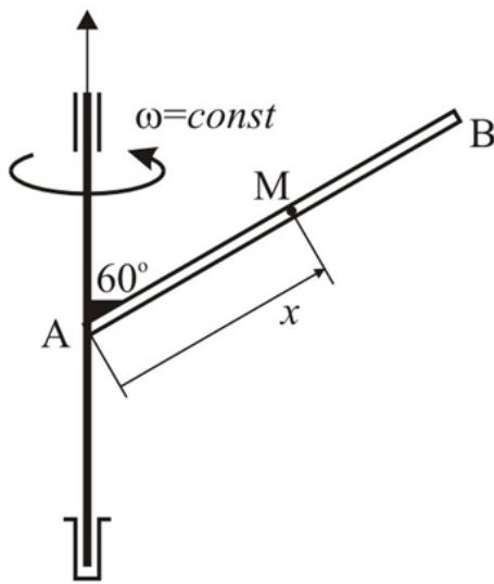
3. Cev AB se obrće oko nepokretne ose konstantnom ugaonom brzinom  $\omega=2\text{s}^{-1}=\underline{\underline{\text{const}}}$ . Sa osom obrtanja cev gradi ugao  $60^\circ$ . U cevi se po zakonu  $x(t)=t^2+t$  [m] kreće tačka M. Odrediti absolutnu brzinu i ubrzanje tačke u trenutku  $t_1=1\text{s}$ .
