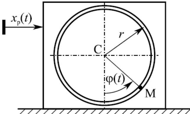
Zadatak 2.27 Pravougaona ploča kreće se translatorno pravolinijski po zakonu  $x_p(t) = v_p t$ , gde je  $v_p = \text{const} > 0$ , u prikazanom smeru. Po kružnom žlebu u ploči, radijusa  $r$ , kreće se tačka M po zakonu  $\varphi(t) = \pi \frac{t^2}{2}$ . Odrediti apsolutnu brzinu i apsolutno ubrzanje tačke M u trenutku  $t_1 = 1\text{s}$ .
