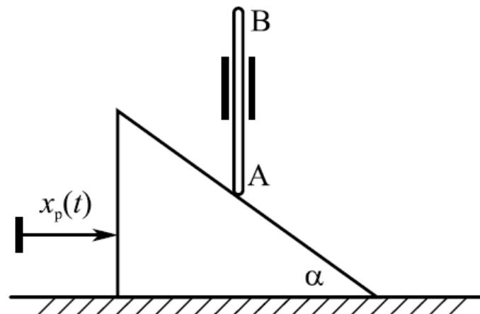
**Zadatak 2.30** Klin, nagibnog ugla  $\alpha$ , kreće se translatorno pravolinijski po poznatom zakonu  $x_p(t)$ . Na njegovu strmu stranu oslanja se štap  $AB$ , koji može da se kreće duž vertikalne vođice. Odrediti apsolutnu brzinu i ubrzanje štapa.
