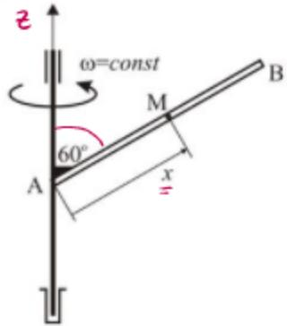
3. Cev AB se obrće oko nepokretne ose konstantnom ugaonom brzinom  $\omega=2\text{s}^{-1}=const$ . Sa osom obrtanja cev gradi ugao  $60^\circ$ . U cevi se po zakonu  $x(t)=t^2+t$  [m] kreće tačka M. Odrediti apsolutnu brzinu i ubrzanje tačke u trenutku  $t_1=1\text{s}$ .
