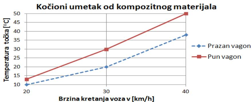
Slika 8.6. Promena temperature točka pri kočenju sa kočionim umetkom od kompozitnog materijala
