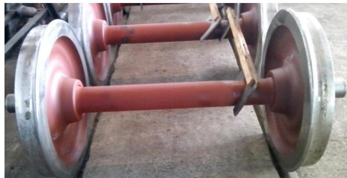
Slika 6.2. Izgled osovinskog sklopa točka
