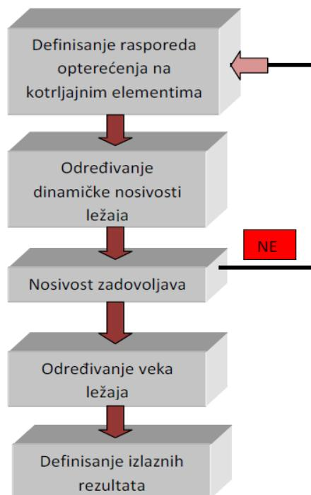
Slika 4.22. Algoritam programskog rešenja za određivanje veka ležaja
