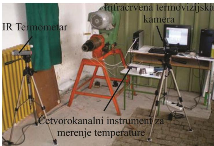
Slika 7.9. Izgled eksperimentalnog štanda sa instrumentima za merenje
