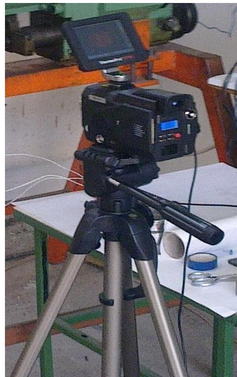
Slika 7.4. Infracrvena termovizionska kamera Thermo Pro<sup>TP</sup> TP8S
