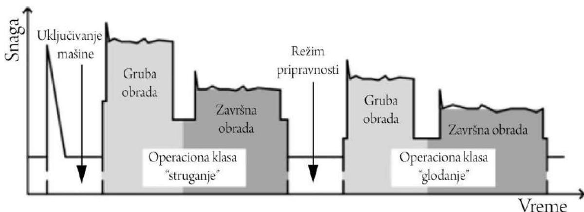
Slika 2.9 Šematske krive snage višestrukih obradnih operacija [138]
