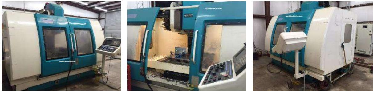
Slika 3.15 Izgled posmatranog vertikalnog mašinskog CNC centra Shizuoka SV-4020
