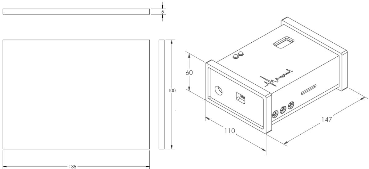
Slika 3.8 Radionički crtež za novo kućište (prikaz donjeg elementa i finalnog sklopa u mm)
