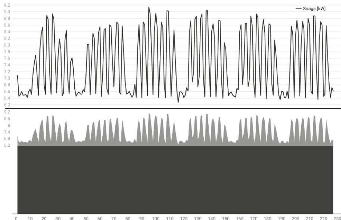
Slika 3.20 Profil angažovane snage sa fokusom uklanjanje materijala
