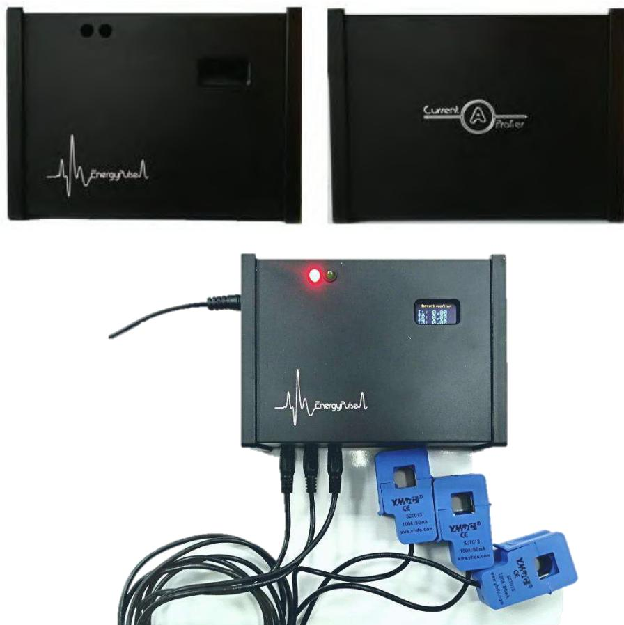
Slika 3.9 Prikaz novoizrađenog kućišta (gore) i finalni izgled uređaja (dole)
