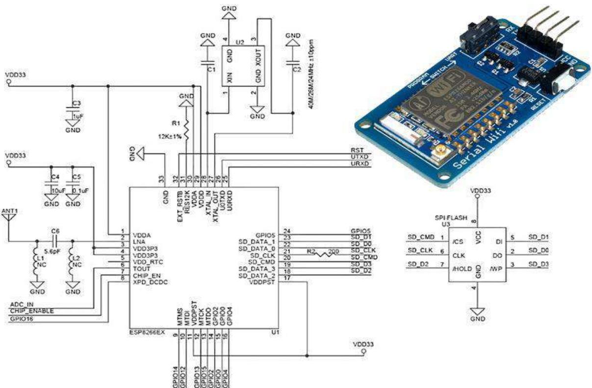
Slika 3.1 Šematski prikaz i izgled ESP8266 WiFi Serial Transceiver modula [226]
