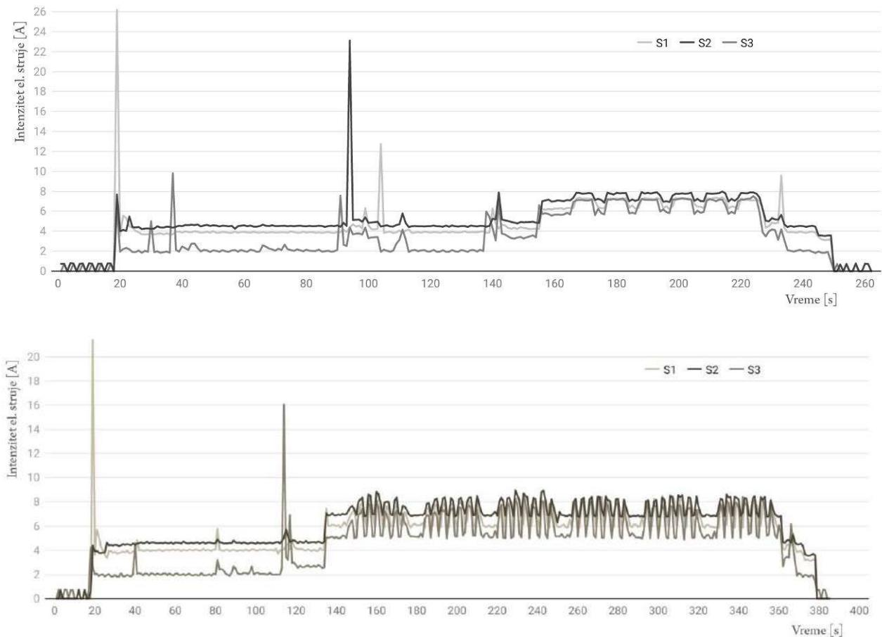
Slika 3.16 Intenzitet struje tokom vremena operacije za: Aluminijum (1), Čelik (2)
