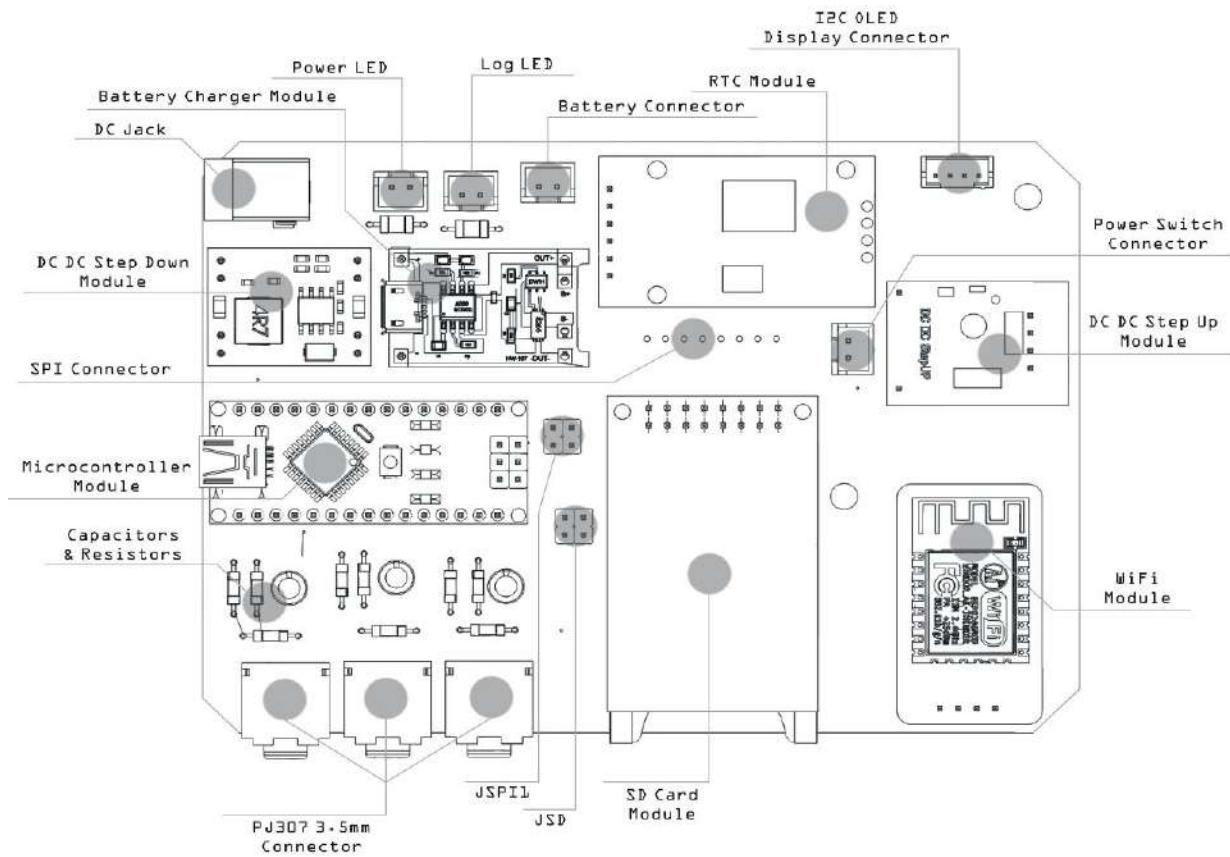
Slika 3.4 Finalni raspored komponenti sklopa elektronike
