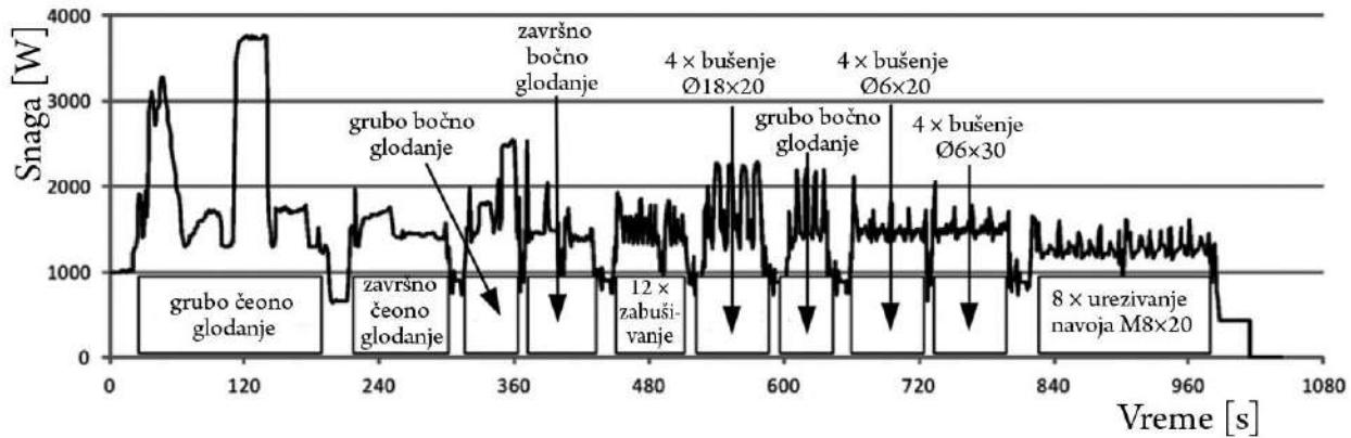
Slika 2.12 Odgovarajuće progresije krive snage za CNC obradni centar [1.38]
