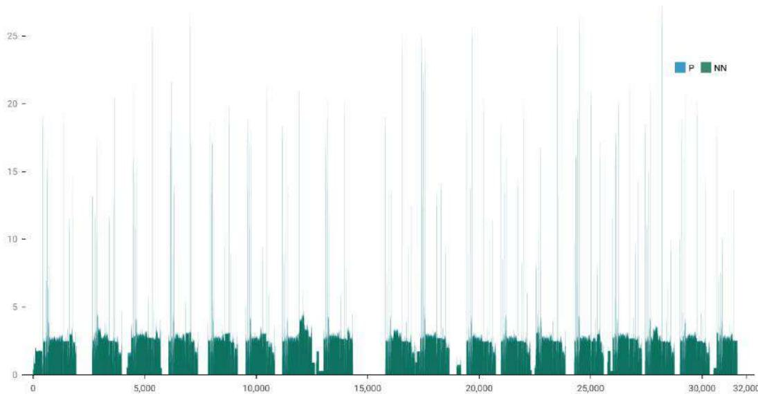
Slika 3.52 Distribucija realnih i modelom generisanih vrednosti tokom vremena ( $y = P, \text{NN} [\text{kW}]$ ;  $x = \text{Samples} [\text{s}]$ )
