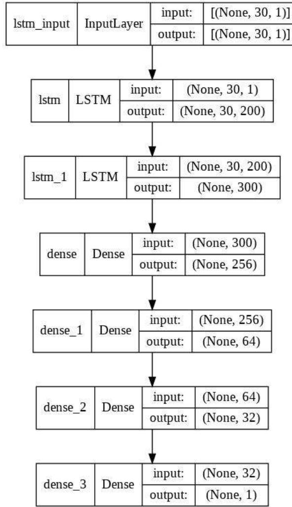
Slika 3.55 Vizuelni prikaz modela sa karakteristikama slojeva
