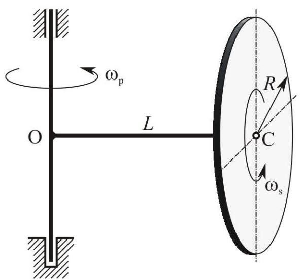
Za vertikalno kruto vratilo vezana je horizontalna osovina OC, dužine  $L=\sqrt{3}$ m, na čijem kraju je cilindričnim zglobom vezan disk, poluprečnika  $R=1$ m. Vratilo se obrće oko vertikalne ose ugaonom brzinom  $\omega_p = 3t$  [s<sup>-1</sup>]. Disk se, dodatno, obrće oko osovine OC ugaonom brzinom  $\omega_s = 2t^2$  [s<sup>-1</sup>]. Odrediti ugaonu brzinu i ugaono ubrzanje diska u trenutku  $t_1=1$ s.
