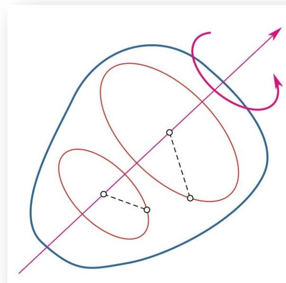
Obrtanje krutog tela oko nepokretne ose je takvo kretanje tela kod kog se njegove tačke kreću po kružnicama čiji je centar na nepokretnoj osi i koje su u ravnima upravnim na tu osu (osa obrtanja).
