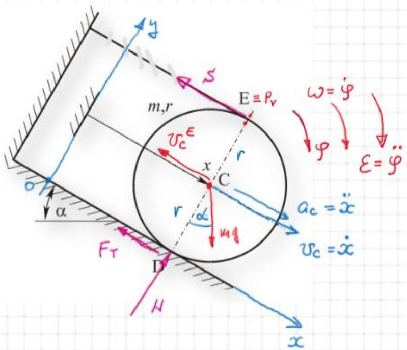
$$T_1 \quad m \vec{a}_c = m \vec{g} + \vec{S} + \vec{N} + \vec{F}_T \quad / \cdot \vec{i} / \cdot \vec{j}$$
