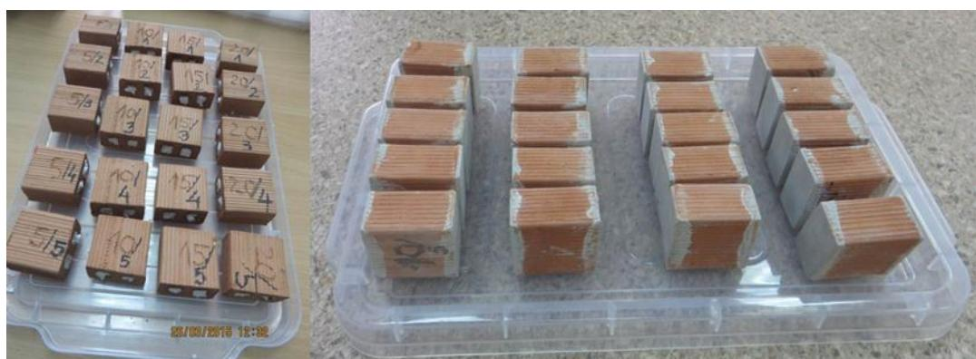
Slika 3.13 Priprema uzoraka za ispitivanje čvrstoće pri pritisku
