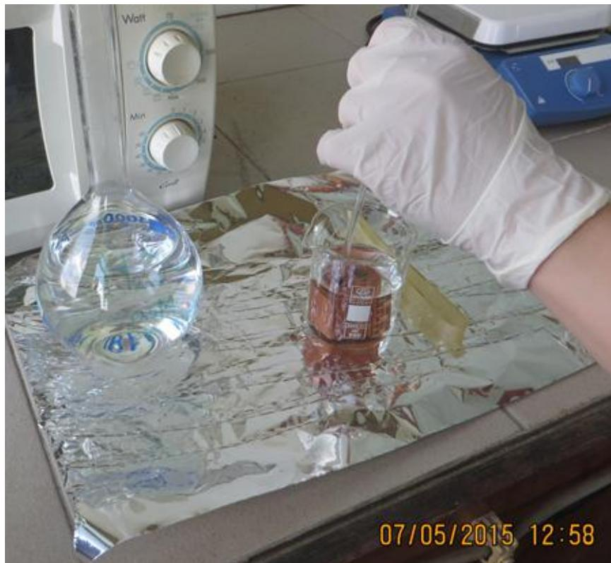
*Slika 3.19 Ispitivanje hemijske stabilnosti uzorka eksperimentalnih blokova sa staklenim reciklatom*
