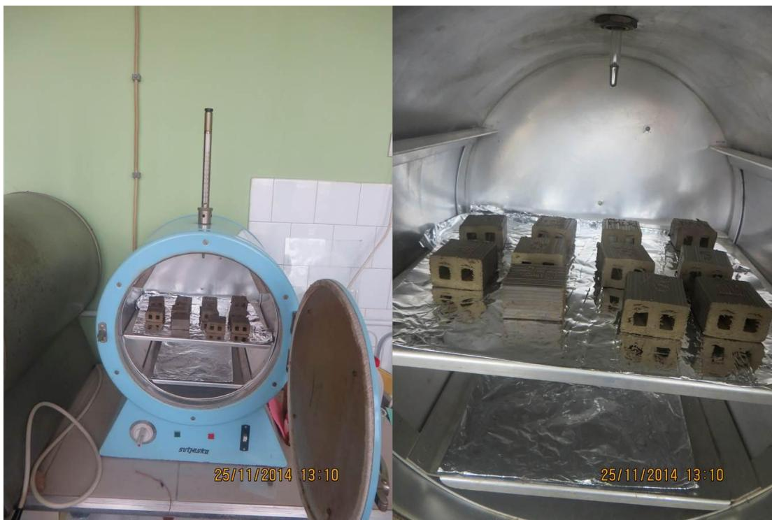
Slika 3.8 Sukcesivno sušenje eksperimentalnih blokova
