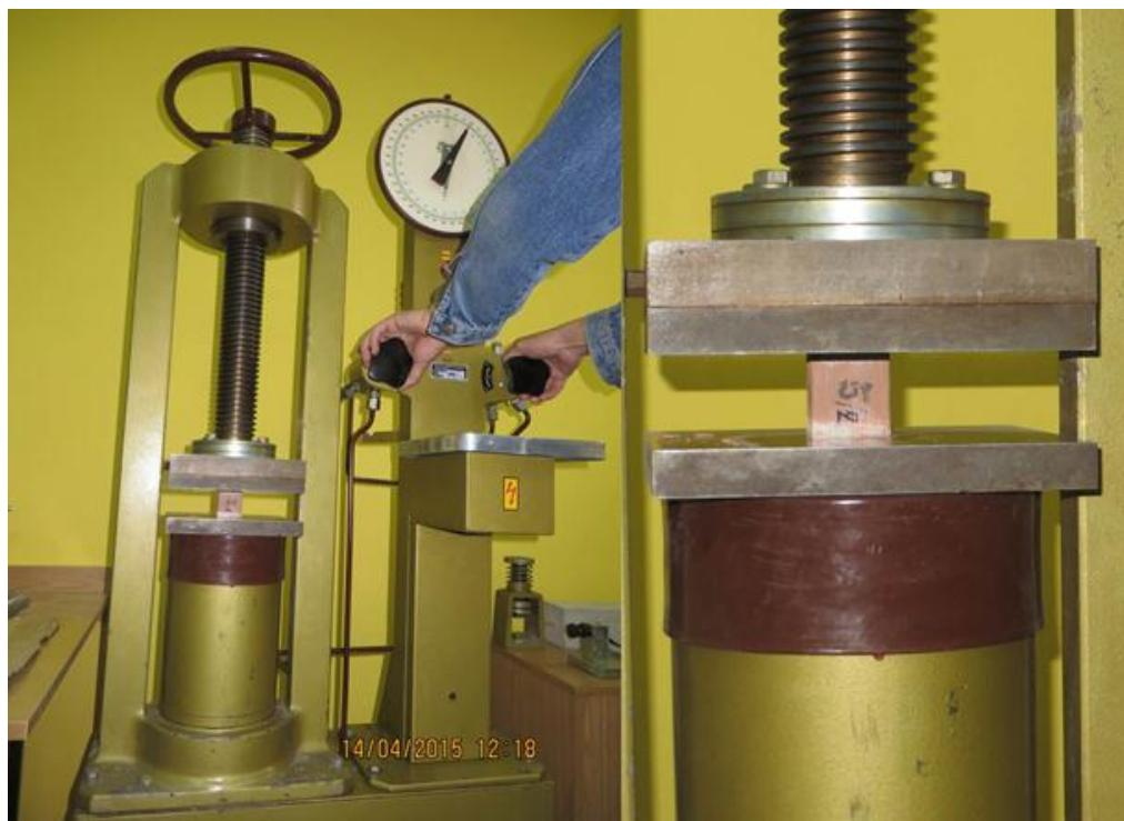
*Slika 3.14 Uređaj za merenje sile loma pri opterećenju na pritisak – hidraulična presa*
