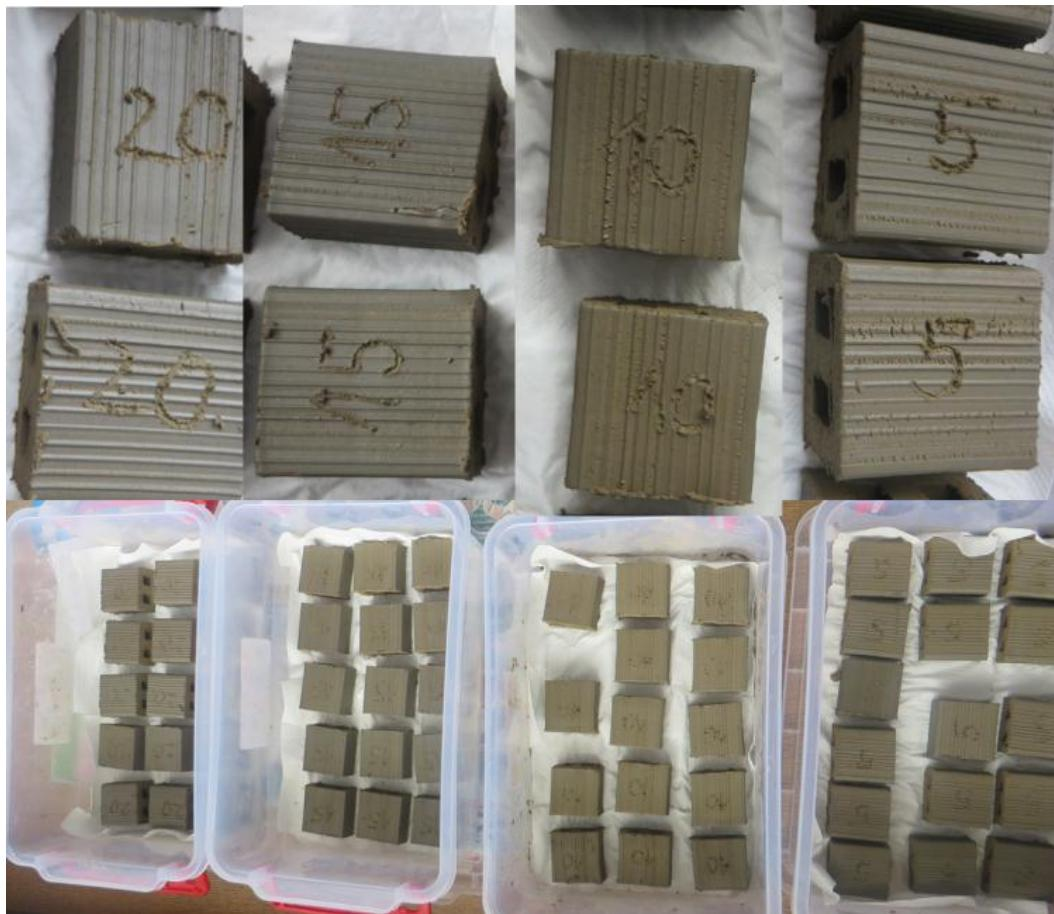
Slika 3.7 Označavanje oblikovanih eksperimentalnih uzoraka blokova sa staklenim reciklatom
